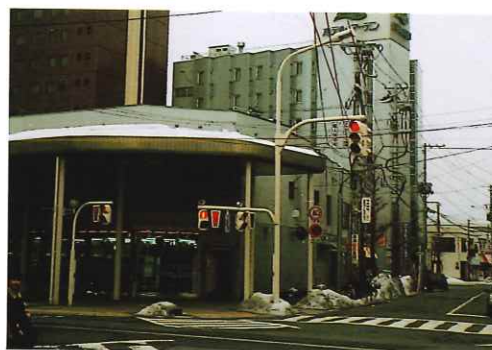
■信号、照明施設等の支柱を共有化し、かつ色彩の工夫により、周辺景観と調和させている
