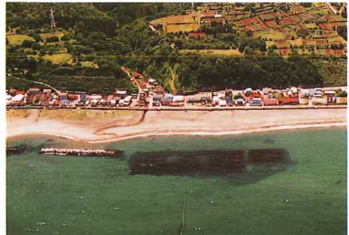
■ 景観阻害要因となる消波ブロックの代わりに人工リーフを用いることで、周辺景観の保全を図っている
