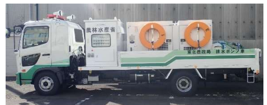
東北農政局土地改良技術事務所 保有の排水ポンプ車
