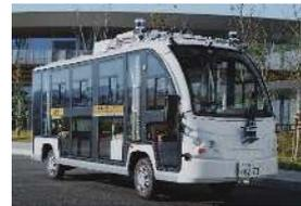
タジマモーターコーポレーション社製「GSM8」を自動運転仕様に改造したモビリティ。世界20か国以上で活用実績のあるオープンソース自動運転ソフトウェアである「Autoware」を搭載。
