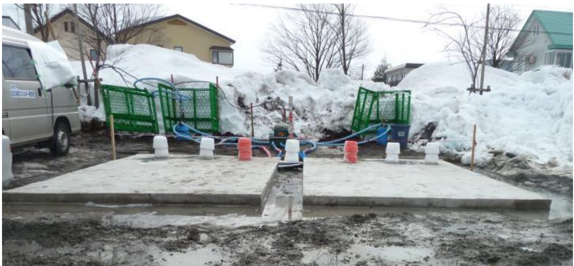
図5.2.1.1 50m深熱交換井戸と10m深交換井戸実証実験
