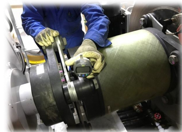
高速軸アライメント測定
