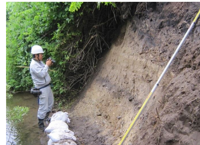
図4 法面観察作業状況(事例)
