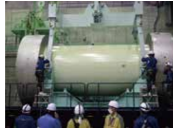
貯蔵建屋内におけるトレーラーからの 金属キャスクの吊り上げ作業
