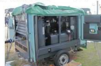
可搬型空気圧縮機
