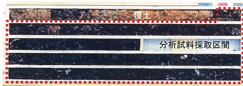
写真 5. 1. 1 バーク堆肥を主体とする廃棄物状況 (No. 10 孔 0.0~5.0m)
