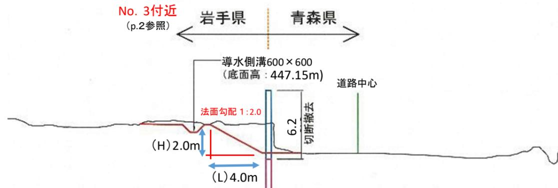
岩手側表流水は側溝等により、南調整池に流下するよう施工
