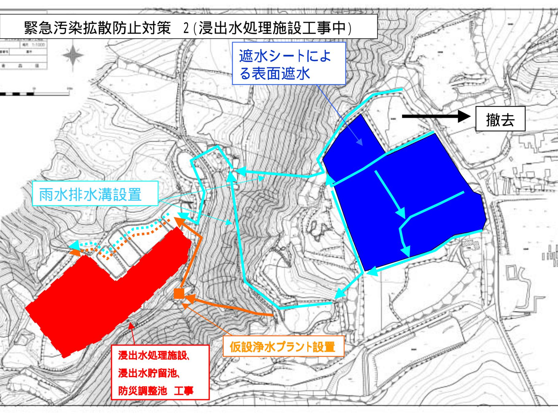
浸出水処理施設稼動開始(鉛直遮水工等工事中)
