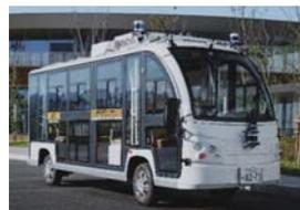
タジマモーターコーポレーション社製「GSM8」を自動運転仕様に改造したモビリティ。世界20か国以上で活用実績のあるオープンソース自動運転ソフトウェアである「Autoware」を搭載。
