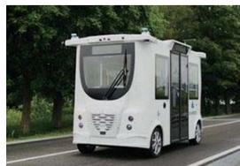
エストニアAuve Tech製。3DマップとLiDARの情報をマッチングして自己位置を推定します。レベル4走行の対応が可能。
