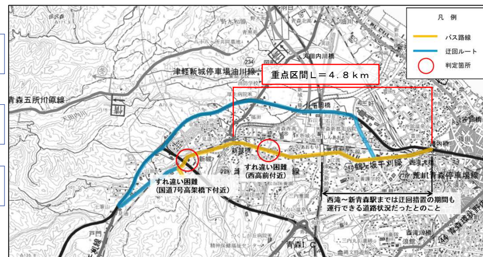
新城線：判定箇所2箇所（幅員狭小によるすれ違い困難）
