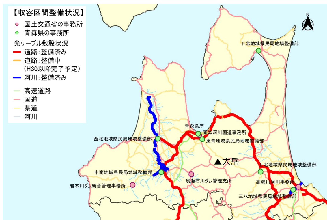
図 3.3.1 八甲田山周辺における国土交通省の光ケーブルの整備状況
