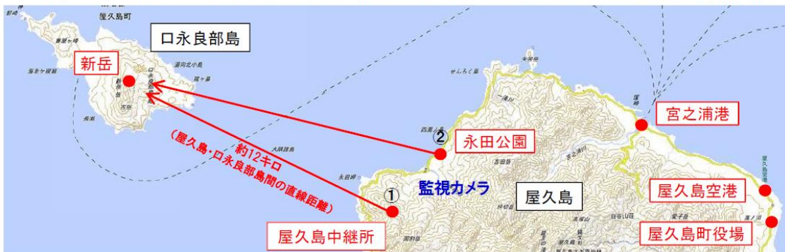
図 3.3.3 口永良部島 2015 年（平成 27 年）噴火における衛星通信車の配置例
