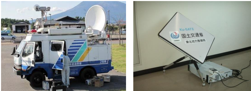
図 3.3.2 衛星系無線通信システムの例 左：衛星通信車、右：衛星通信可搬局装置（Ku-SAT II）外観（国土交通省東北地方整備局所有）
