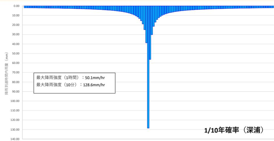
基準降雨波形：中央集中型1/10降雨波形
