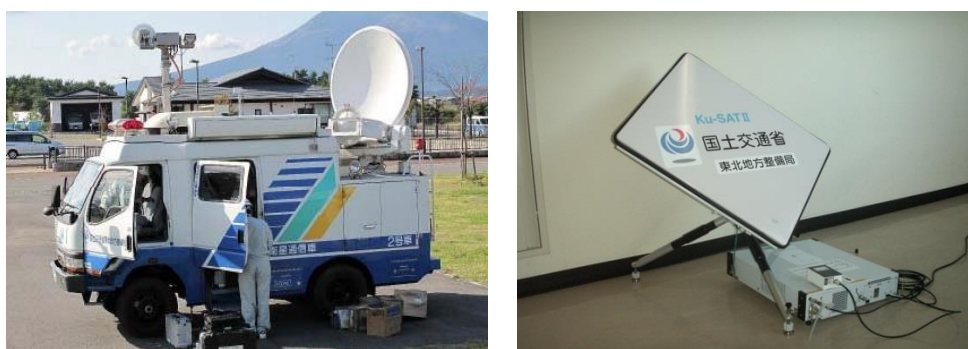
図 4.7.1 衛星系無線通信システムの例 左：衛星通信車、右：Ku-SAT可搬局外観（国土交通省東北地方整備局所有）
