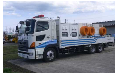
排水ポンプ車 (30m 3 / min高揚程)
