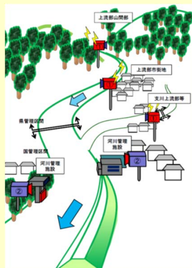
(参考)イメージ 簡易型河川監視用カメラ
