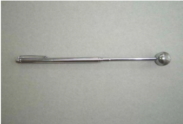
打診棒ロング (仕上材の浮きを調べる)
