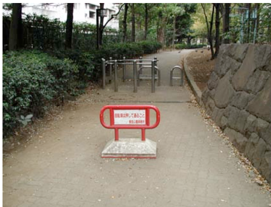
公園の出入口に車止めを設置した例
