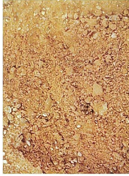
礫混じり砂質土：礫質土に比べて礫の混入量が少ない。砂が主体で粘性土を含まないもの。 (第3種) 手で持ってもべとつかない。
