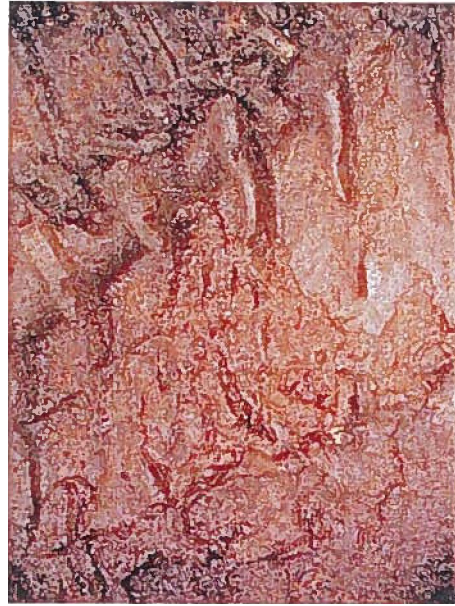
粘性土：粘性土が主体で常に軟らかい状態である。手でさわると「ベタベタ」で、極めて軟らかい状態である。ブルドーザーの走行が困難である。 (第4種)
