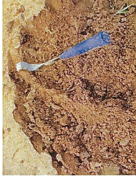
砂質土：ほとんどが砂主体で、手で持つと「さらさら」した感じ。 (第3種) 粘性土を含む所は強く握ると固まるが、その部分が全体では少ないもの。
