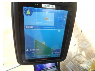
【ICT建機モニター確認状況】
