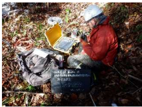
弾性波探査測定状況
