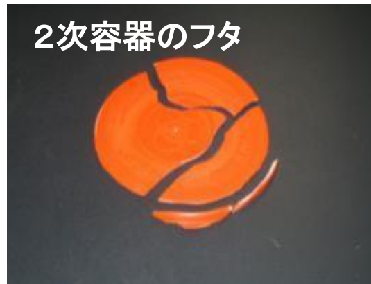
カテゴリAの運搬容器 (破裂して飛び散る)
