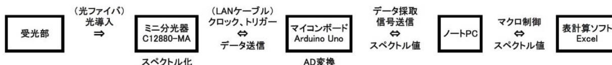
図1 測定システムの概念図
