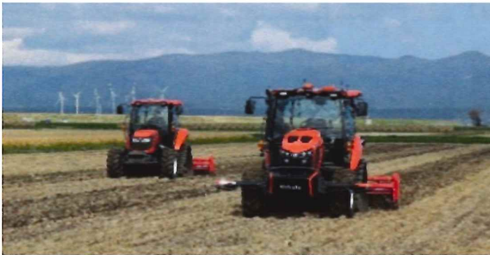
既存機がロボットトラクタを監視して2台で耕起
