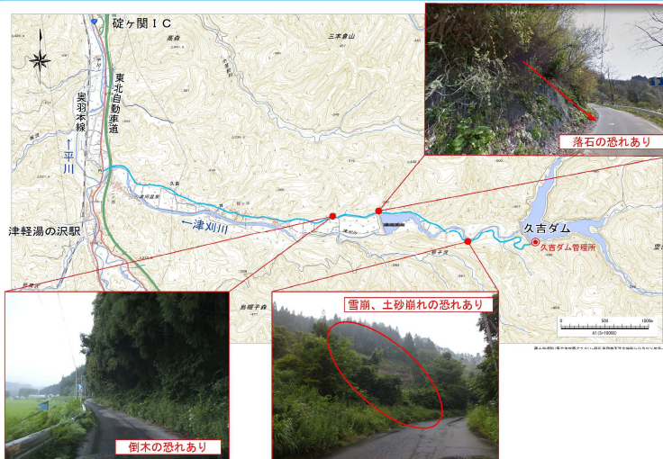
ダムへのアクセス道路の危険箇所
