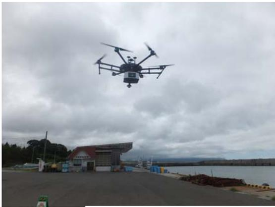
＜UAVレーザー計測状況＞
