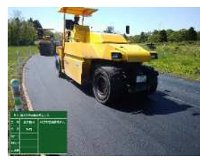
締固め機械(樹脂製タンク採用)
