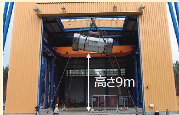
1/1スケールモデルでの9m落下試験の例 出典：三菱重工技報 VOL.43 NO.4: 2006
