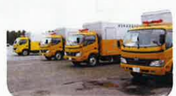
電源車 (海拔2.3mに配備)
