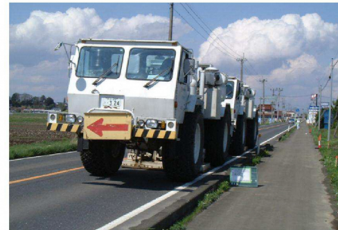
反射法地震探査で使用する起震車(イメージ)
