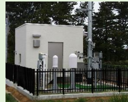
モニタリングポスト モニタリングステーション (空間放射線量率を連続測定)
