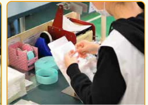
フック付け：手作業で一つ一つ取り付けています
