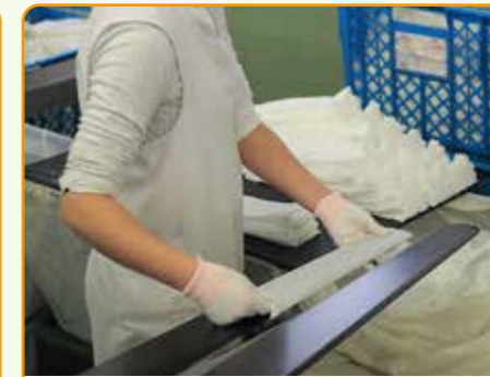
揃え：生地を足型に通し、染色時に斑にならない様に伸ばしています
