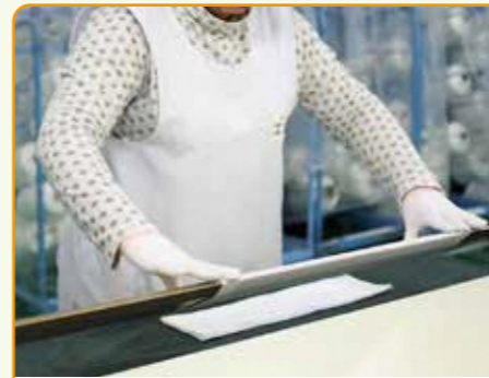
伸ばし：両端の空いた円筒状の生地を専用アイロンで伸ばしています
