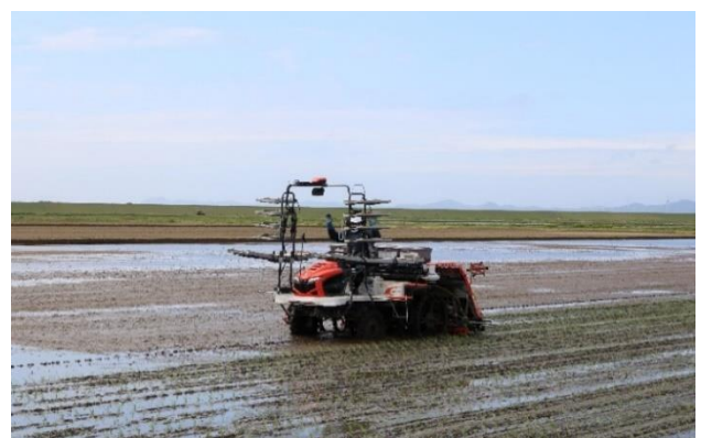
自動直進田植機による田植え ・作業経験の少ない者が運転しても熟練者 と同等の作業が可能
