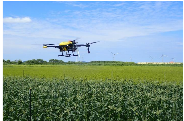
ドローンによる農薬散布 ・作業時間の削減、人が入りにくい場所での防除作業を軽労化
