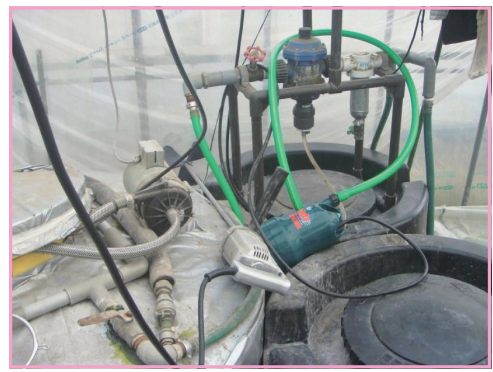
独自の養液土耕システム（希釈装置、タンク）
