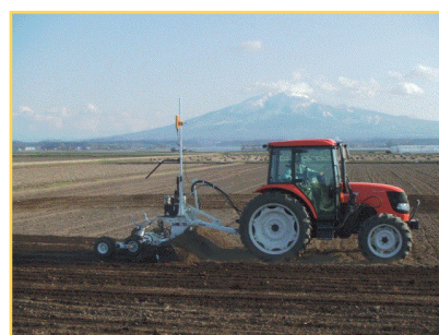
レーザーレベラでの均平作業
