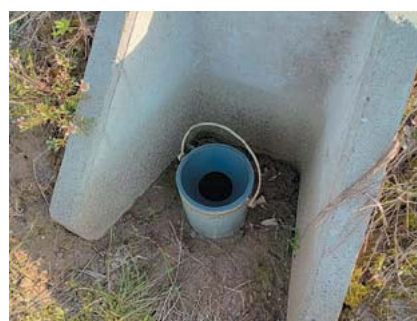
内円筒をスライドすることで、水位を任意の位置に調整することが可能です。
