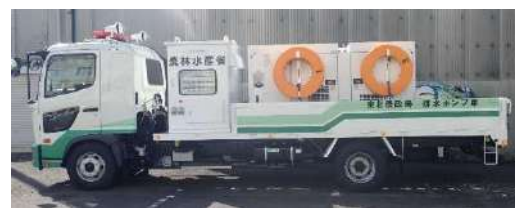
東北農政局土地改良技術事務所 保有の排水ポンプ車
