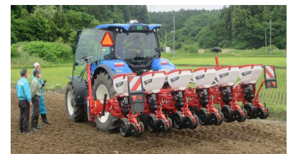
セクションコントロール機能付きバキュームシーダー
