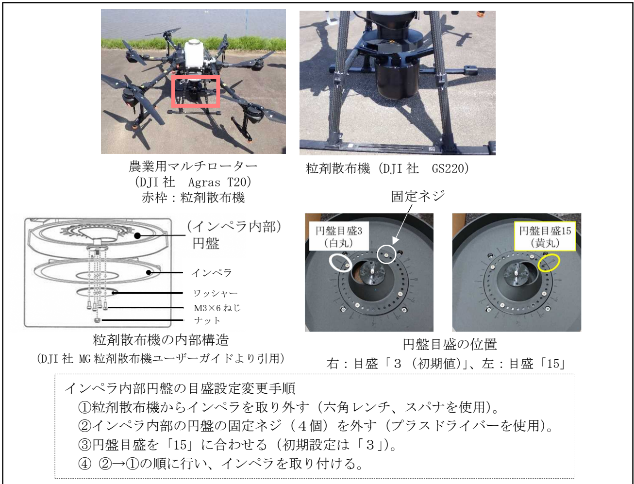
図1 粒剤散布機 (DJI 社 GS110、GS220 等) におけるインペラ内部の円盤目盛の変更方法
