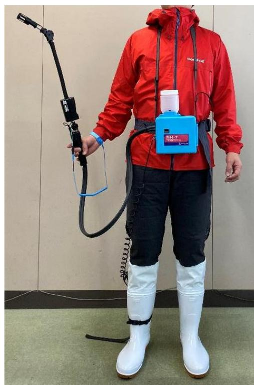
図1 静電風圧式受粉機（花粉交配機ラブタッチ SK-7「交配用静電ノズル」）
