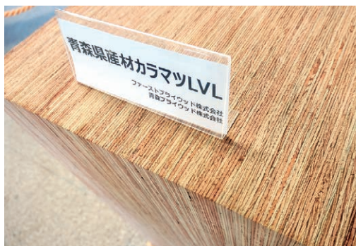
薄くスライスした単板を重ねて作られるLVL材。 校舎の木材は、青森県産材使用のLVL材が多くを占める。 （2024年6月の構造躯体見学会にて）
