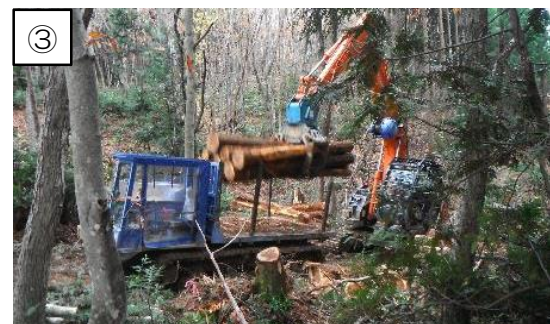
③ 切り分けた丸太をフォワードに積み、山土場まで運搬します。
