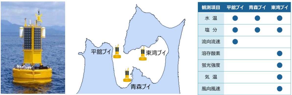
図11 ブイロボ(第5世代)の外観、設置位置及び観測項目
