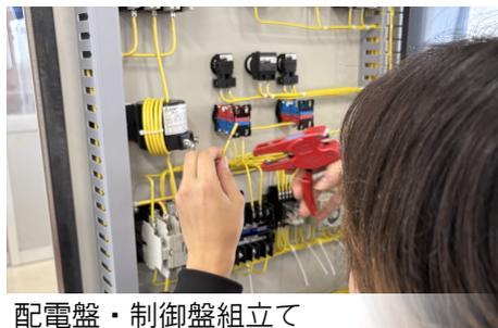
配電盤・制御盤組立て
