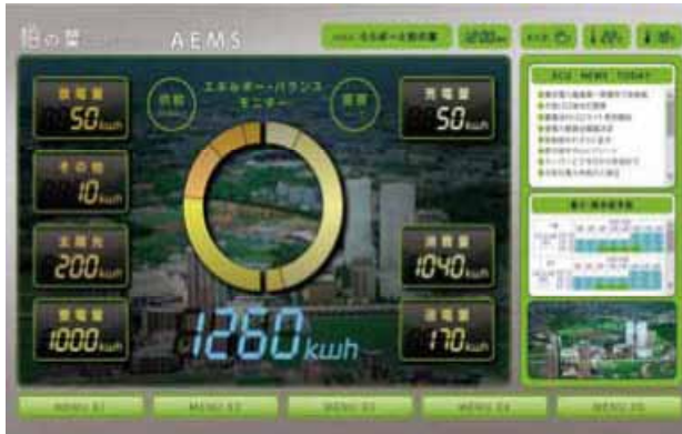
図4-12 エリア・エネルギー管理システム(AEMS)のモニターイメージ
