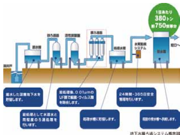
図4-16 商業施設「ららぽーと柏の葉」の地下水利用フロー
