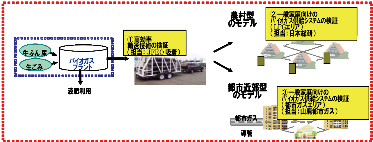
図4-38 バイオガスの精製・輸送・貯蔵技術を用いた家庭向けの精製メタンガス供給モデル事業(山鹿市)
