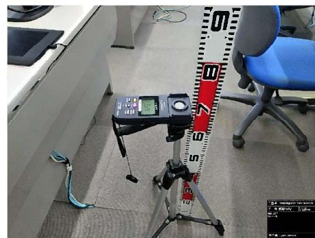
照度測定状況
